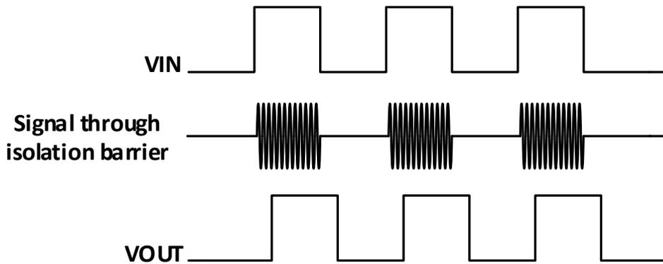
图 9-2 OOK 开关键控调制方案波形示意图
