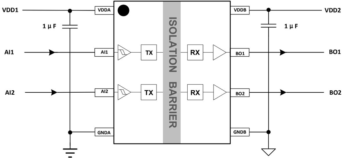
图 10-1 SOIC8 CA-IS3720VLS 典型应用电路
