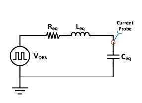
图 3 栅极驱动电路等效模型
