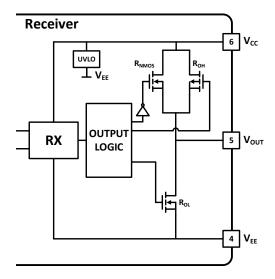
图 2 输出级结构
