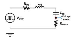
图 7 采样电阻测量方案
