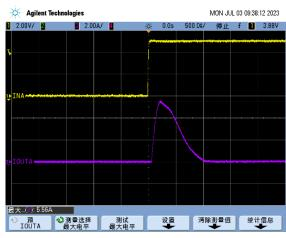
图 4 电容充电电流波形
