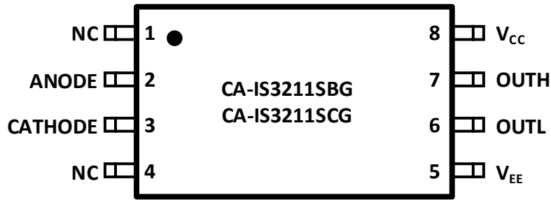
图 5-3 CA-IS3211SBG/ CA-IS3211SCG SOIC8-WB 配置
