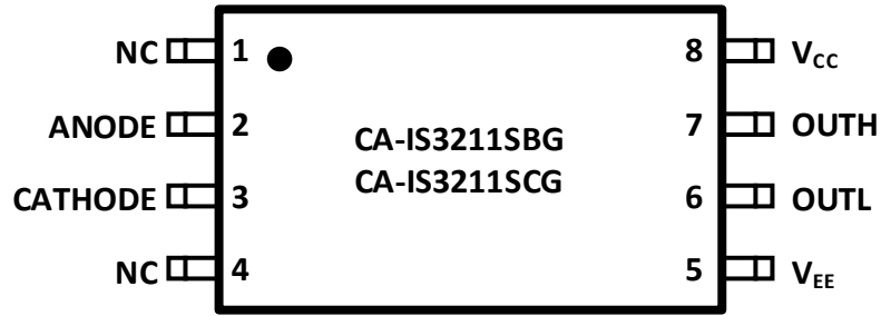
图 6-2 CA-IS3211SBG/ CA-IS3211SCG SOIC8-WB 配置
